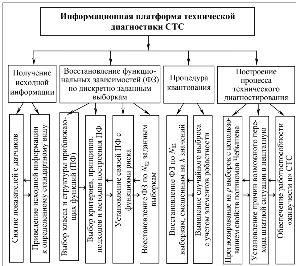
Рис. 3. Структурная схема информационной платформы технической диагностики СТС
