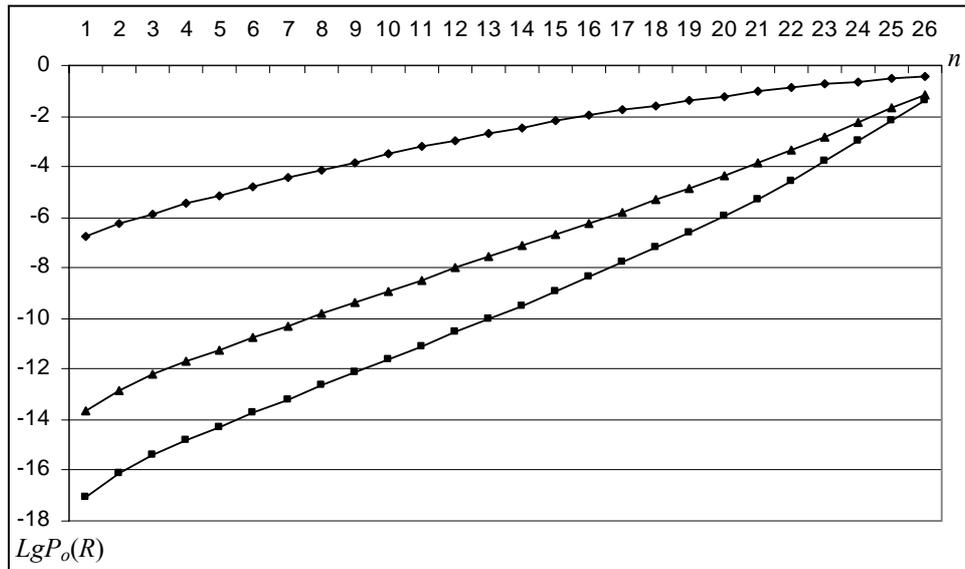
Рис. 7. Зависимость вероятности потери  $o$ -вызовов от числа резервных каналов в модели с конечной очередью (▲ —  $R=7$ ; ■ —  $R=15$ ; ◆ —  $R=1$ )
