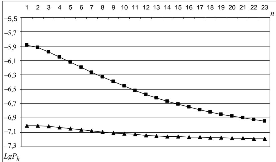
Рис. 3. Зависимость вероятности потери  $h$ -вызовов от числа резервных каналов в модели с бесконечной очередью ( $\blacktriangle$  —  $\lambda_0=2$ ;  $\blacksquare$  —  $\lambda_0=4$ )
