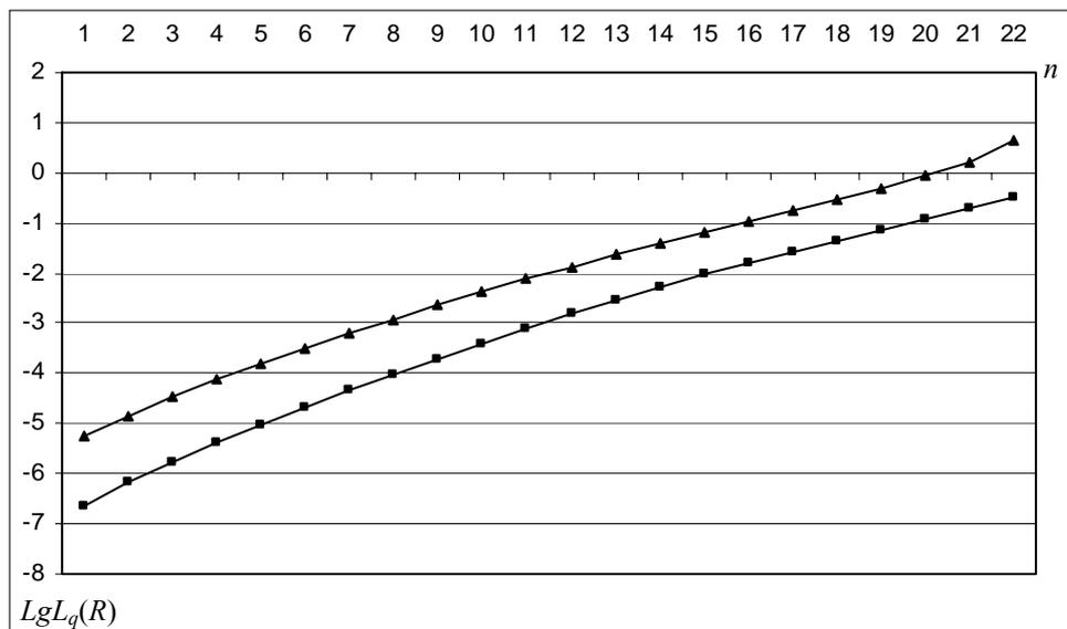
Рис. 8. Зависимость средней длины очереди  $o$ -вызовов от числа резервных каналов в модели с конечной очередью (▲ —  $\lambda_o=4$ ; ■ —  $\lambda_o=2$ )
