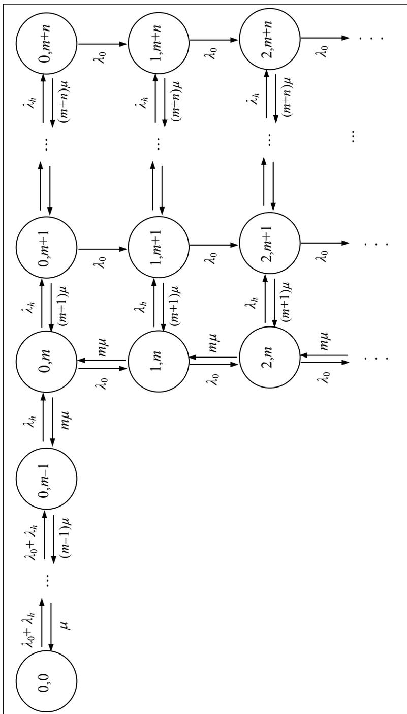
Рис. 2. Граф переходов между состояниями модели с бесконечной очередью *o*-вызовов
