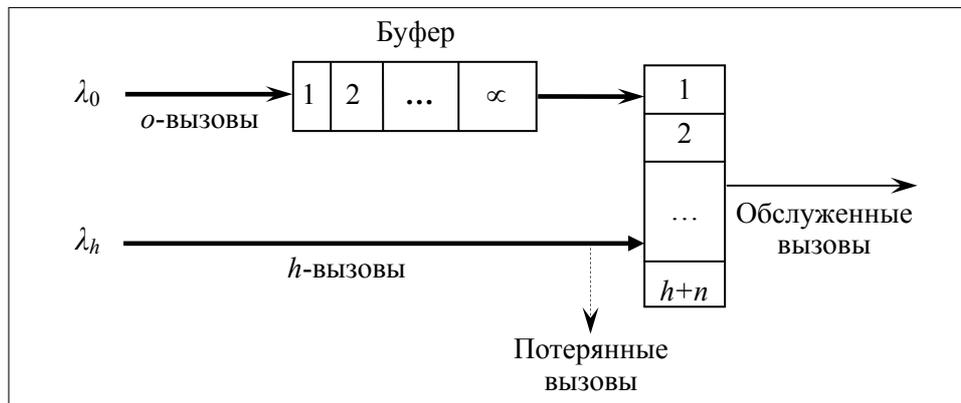
Рис. 1. Структурная схема исследуемой системы
