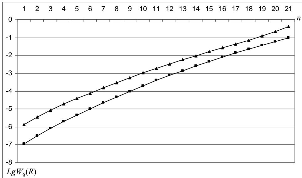
Рис. 9. Зависимость среднего времени ожидания о-вызовов от числа резервных каналов в модели с конечной очередью (▲ —  $\lambda_0=4$ ; ■ —  $\lambda_0=2$ )
