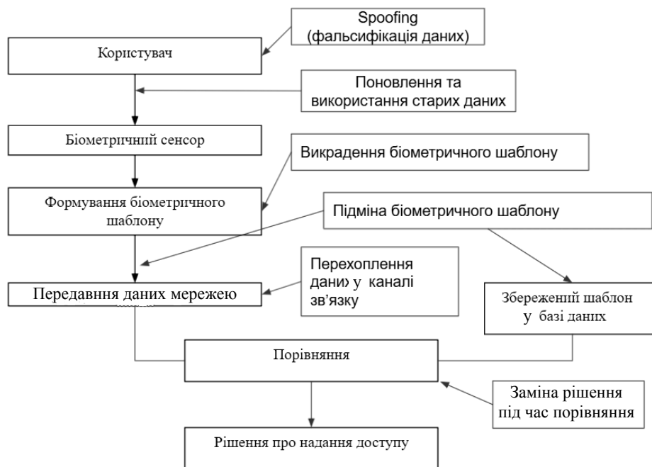
Рис. 2. Можливі вразливості в системі віддаленої біометричної автентифікації
