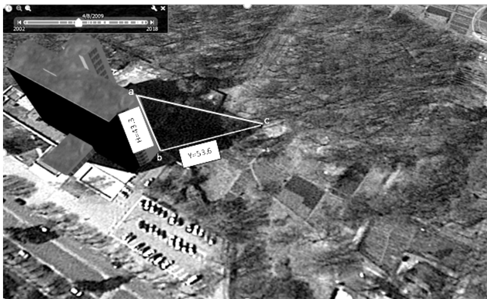
Рис. 3. Прямоугольный треугольник, образованный известными длиной тени и высотой здания (снимок из Google Earth)
